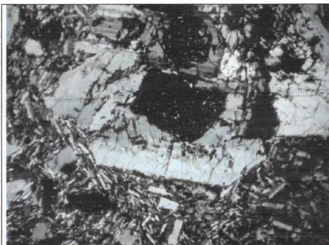
Figura 9.1.1. Seção delgada de traquito mostrando inclusões de xenólitos em plagioclásios (polarizador cruzado em objetiva de 4x).
