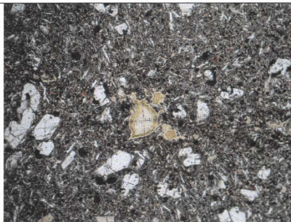
Figura 9.1.3. Seção delgada de basanito exibindo vesícula com preenchimento hidrotermal (luz polarizada em objetiva de 4x).
