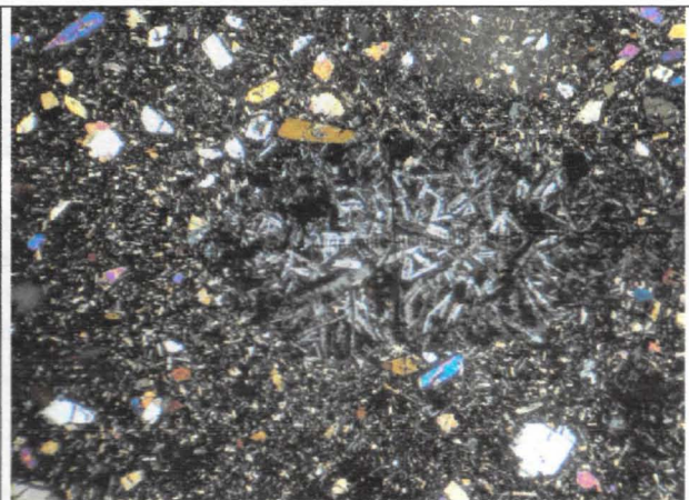
Figura 9.1.3.1. seção delgada de basanito mostrando xenólito de plagioclásio (polarizador cruzado em objetiva de 10x).
